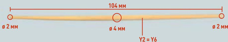
6 Возьмите стержень диаметром 4 x 300 мм, полученный с данным выпуском. Отрежьте от него два фрагмента длиной 104 мм каждый. Заузьте эти фрагменты так, чтобы диаметр их концов составлял 2 мм. Пометьте два полученных рея аббревиатурами Y2 и Y6.
