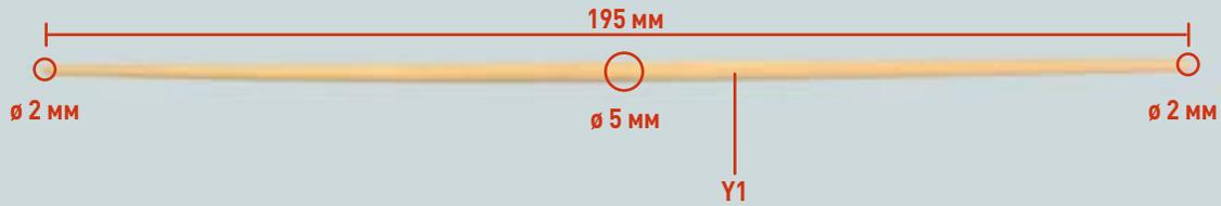
5 Возьмите стержень диаметром 5 x 300 мм, полученный с данным выпуском. Отрежьте от него фрагмент длиной 195 мм, затем заузьте его так, чтобы диаметр его концов составлял 2 мм. Пометьте этот рей аббревиатурой Y1.
